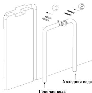
1. Проверьте отверстия в стене в соответствии с размером корпуса смесителя, далее зафиксируйте смеситель с помощью саморезов. Соедините смеситель с трубами подвода.
