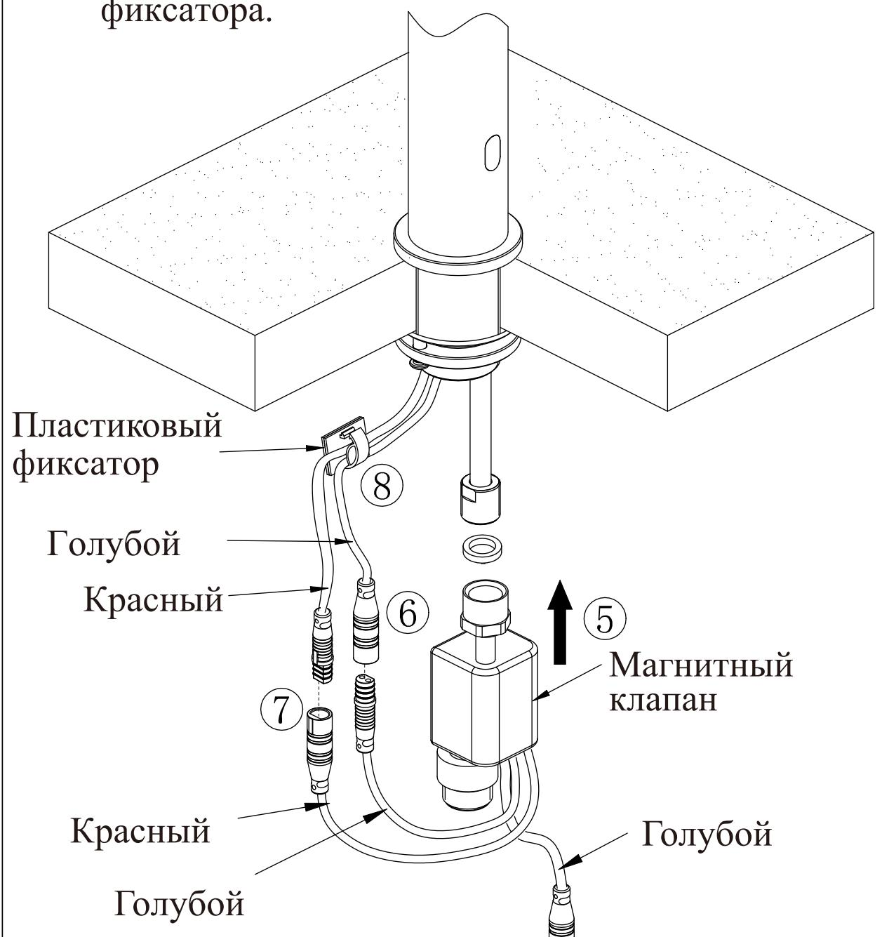
**5** Соедините магнитный клапан и угловой клапан
