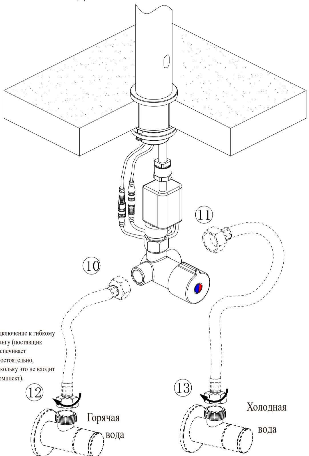
**7** Включите воду и убедитесь в отсутствии протечек. Затем установите и подключите батарейный блок
