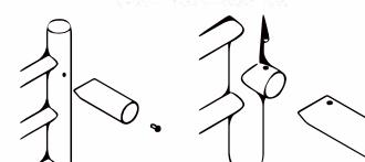
3. Затем возьмите полотенцесушитель и приложите его к стене в нужном месте. Кронштейн со стороны вывода провода совместите с монтажной пластиной, за которой проложен провод. Выровняйте полотенцесушитель по уровню. Наконец, отметьте карандашом на стене позиции трех оставшихся кронштейнов, после чего уберите корпус полотенцесушителя.
