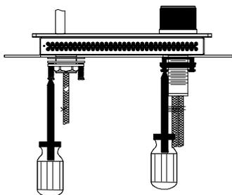
5. Подсоедините и зафиксируйте шланги к водорозеткам. Синий – к холодной воде.
