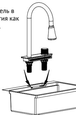
3. Установите шайбы и затяните гайки.
