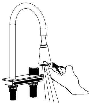
6. В случае снижения напора подачи воды, снимите разбрызгивающую головку и очистите аэратор. Установите головку на смеситель.
