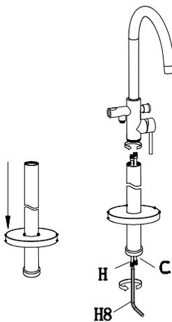
5. Соедините корпус смесителя с трубкой.
