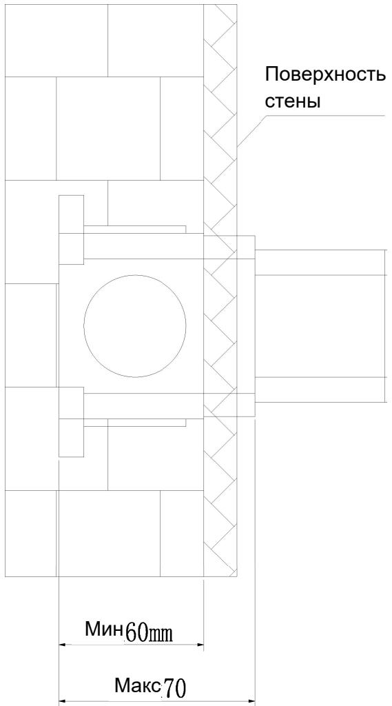
Установите верхнюю рукоятку выемкой вертикально вверх до упора и прижмите, чтобы затянуть винт и рукоятку. Плотно прижмите всю рукоятку, чтобы было слышно, что она вошла до конца.
