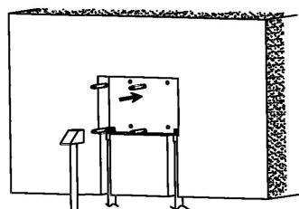
2. В соответствии с размерами, просверлите в стене 4 отверстия диаметром 10 мм.
