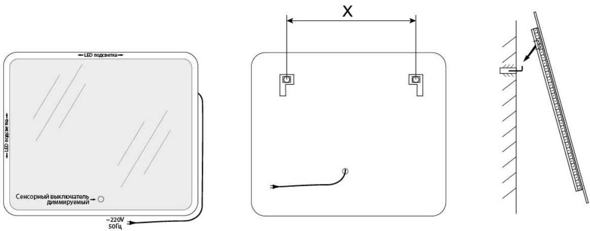
Для моделей с сенсорным выключателем: прикоснитесь пальцем к светящейся области сенсорного выключателя. Если сенсорный выключатель имеет функцию плавного диммирования (\*зависит от модели) с запоминанием последнего значения - короткие касания светящейся области включают/выключают подсветку, длительное касание меняет яркость свечения.
