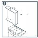
Plastic dowels and hanging parts will be fixed to the wall. Закрепите пластиковые дюбели и подвесные детали на стене
