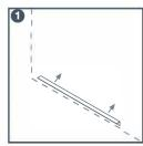
The feet are monted with 3.5x20 The feet are monted with 3,5x20 screws to the side cabinet. Ножки крепятся к боковому шкафу с помощью крепежных винтов 3,5x20.
