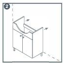
Lower unit is put its own place then adiu ted with rew under the feet. Установите тумбу на место и зафиксируйте ножки крепежными винтами.
