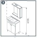
Upper unit will be hanged on the wall. Закрепите верхнюю часть гарнитура на стене.
