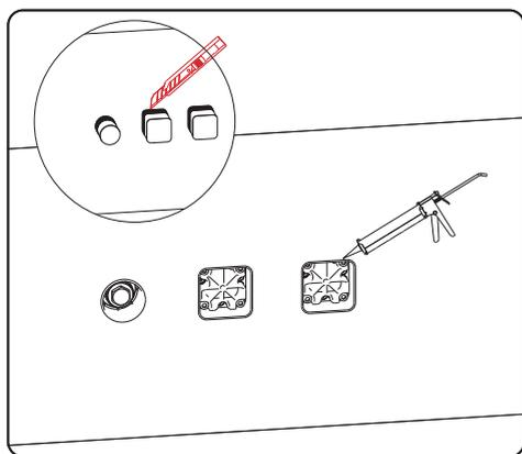
Нанесите силиконовый герметик на заднюю кромку накладки и аккуратно вдавите в нужном положении. Используйте уровень для выравнивания декоративных накладок.
