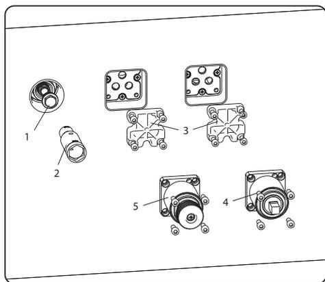
Прикрутите соединительную трубку в резьбовое отверстие и установите держатель для душа.
