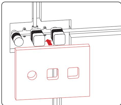
Используя шаблон, вырежьте отверстие в плитке, затем соответствующим образом уложите плитку.
