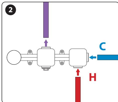
Подсоедините корпус встроенного блока к водопроводу, используя соответствующие фитинги, (С) – входное отверстие для холодной воды, а (Н) – входное отверстие для горячей воды.
